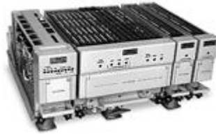
Рис. 3.31. Внешний вид базового комплекса ЦВМ «Орбита-20».
