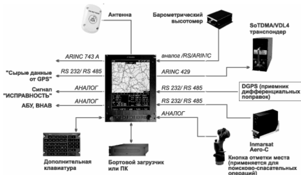
Рис. 1.19. Схема подключения АБРИС
