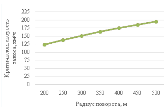
Рисунок 1 - Зависимость критической скорости заноса автомобиля от радиуса поворота
