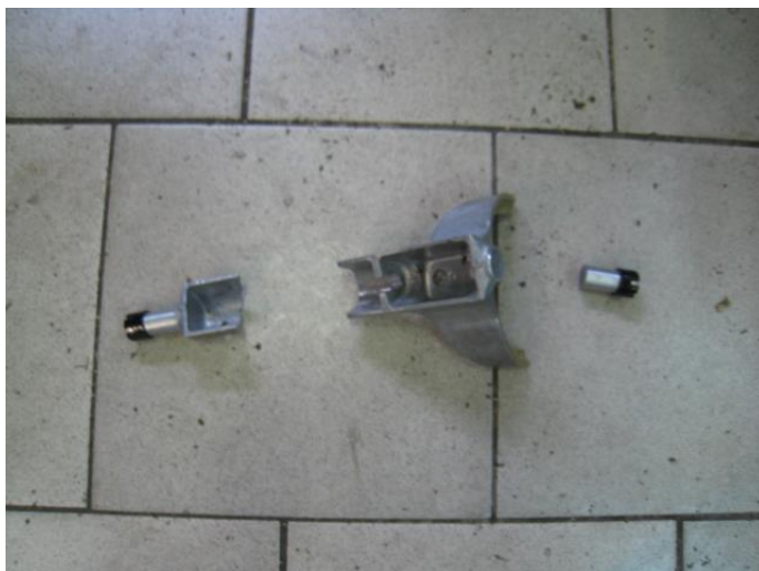
Рисунок 2 - Дефект вилки 6-7 передач BMW M 6
