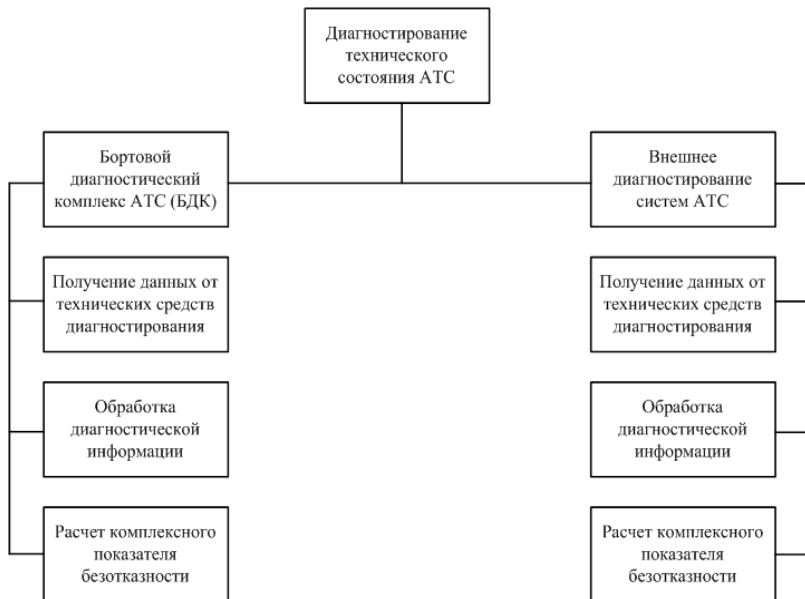
Рисунок 4 – Автоматизация процессов получения и обработки диагностической информации о работоспособности систем автомобиля, влияющих на БДД и расчета комплексного показателя безотказности
