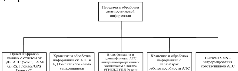
Рисунок 5 – Автоматизация процессов передачи диагностической информации о работоспособности систем автомобиля, влияющих на БДД, и принятии управляющих решений по допуску транспортной машины к эксплуатации
