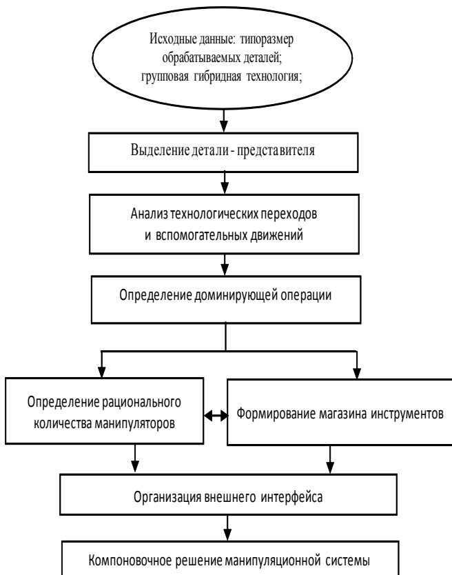
Рисунок - Последовательность функционального комплексирования манипуляционной исполнительской системы для выполнения гибридных операций в производстве
