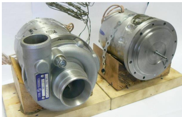
Рисунок 3 - Внешний вид разработанного компрессора с электроприводом
