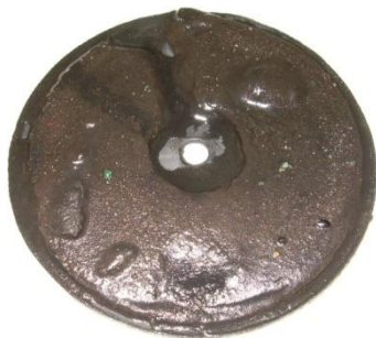
Рисунок 2 - Внешний вид резиновой уплотнительной прокладки со слоем загрязнений, удаленных из охлаждающей жидкости автобусного дизеля (диаметр резиновой прокладки – 102 мм)
