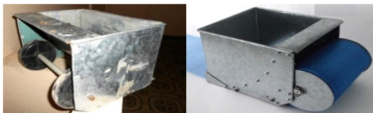
Рис. 3. Каретка-дозатор строительного раствора ( a ) [4] и переносной укладчик сетки и раствора ( б ) [8]
