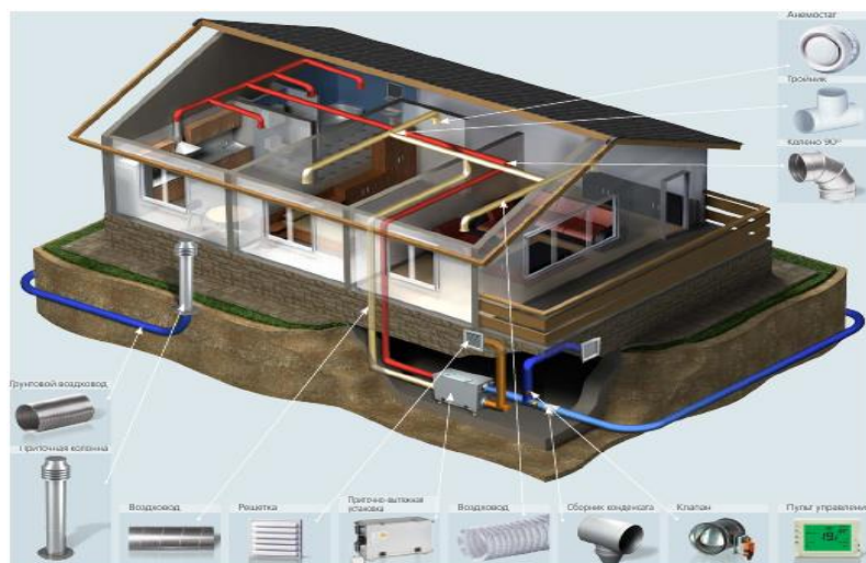
Рис.1. Принципиальное устройство системы в здании.
