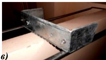
Рис. 2. Устройство для разравнивания растворной постели (а) и сменные гребёнки (б, в) [3]
