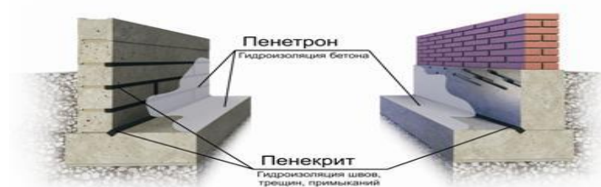
Рис.4 Взаимное расположение пенекрита и пенетрона
