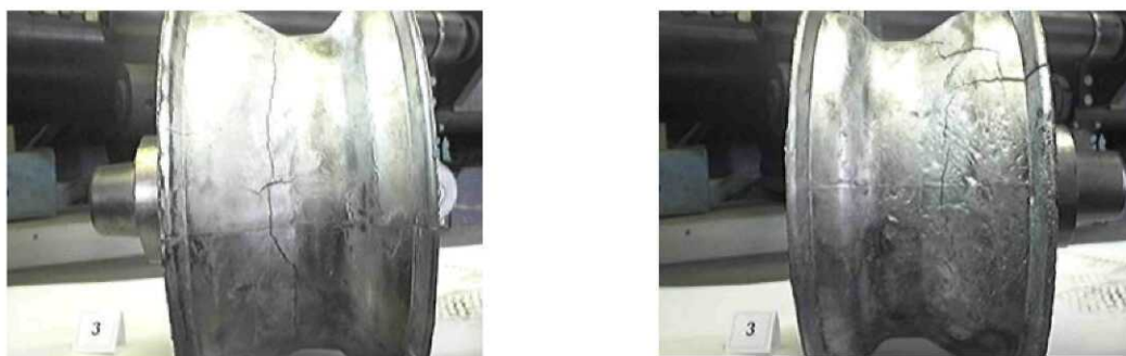
Рис. 52. Продольные и поперечные трещины (эксперимент 3)
