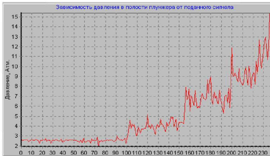
Рис. 28. Нарастание давления в полости гидроцилиндра в режиме широтно-импульсной модуляции сигнала на клапан
