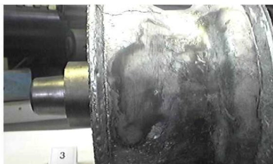
Рис. 53. Опрессованный участок поверхности обода (эксперимент 3)
