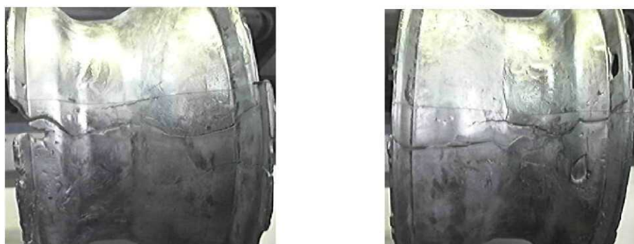
Рис. 51. Неспаи по ободу отливки (эксперимент 3)
