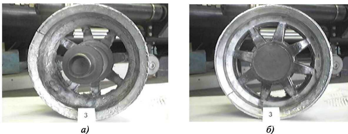
Рис. 50. Внешний вид отливки (эксперимент 3): а – вид со стороны пресс-остатка; б – вид со стороны лицевой поверхности
