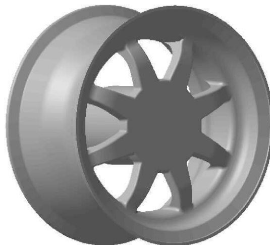
Рис. 41. Конструктивное исполнение опытной литой заготовки
