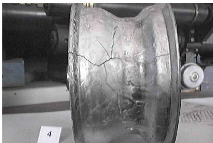
Рис. 62. Трещины по ободу диска (эксперимент 4)
