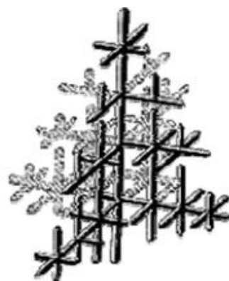
Рис. 2.5. Схема древовидного кристалла Чернова
