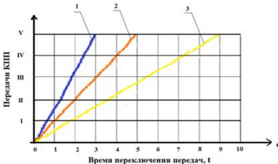
Рис. 2 – Сравнение скоростей переключения передач: 1 – СКПП; 2 – АКПП; 3 – МКПП
