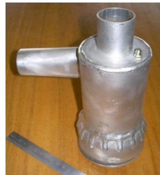
Рис. 1 Внешний вид опытного образца фильтра охлаждающей жидкости
