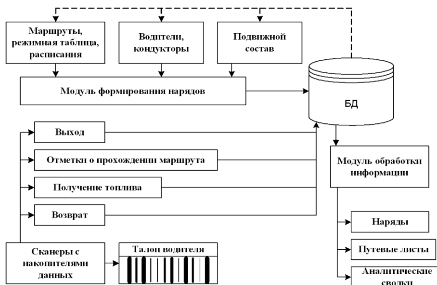
Рис. 1. Структурная схема подсистемы учета работы пассажирского транспорта с применением штриховой идентификации
