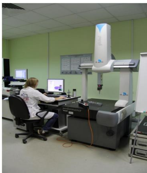
Рис.1 Координатно-измерительная машина КИМ GLOBAL-5.05.0
