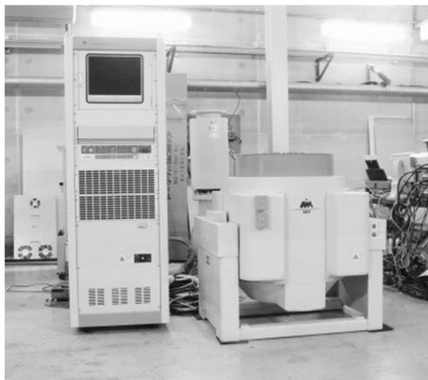
Рисунок 7. Виброустановка для испытания изделий и компонентов на механические воздействия и исследования воздействия вибрации и удара на рабочие характеристики изделий и материалов.
