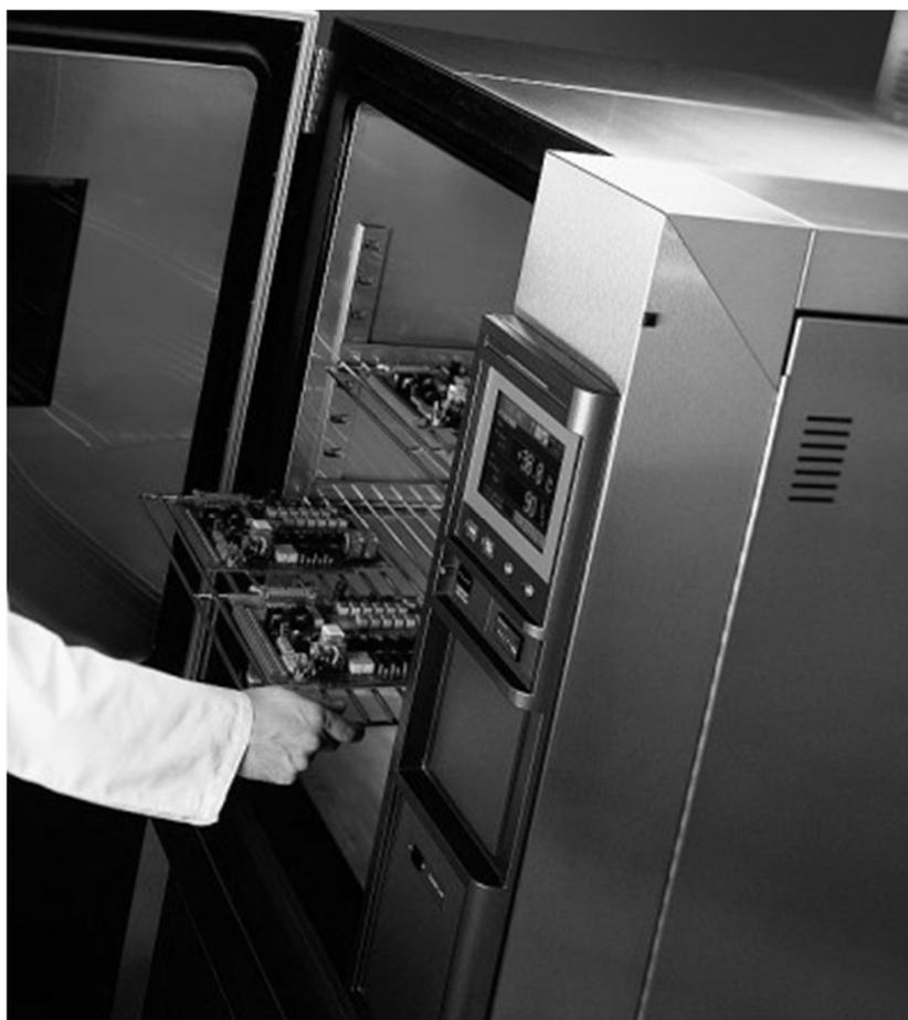
Рисунок 6. Климатическая камера, предназначенная для проведения испытания готовых изделий и компонентов.
