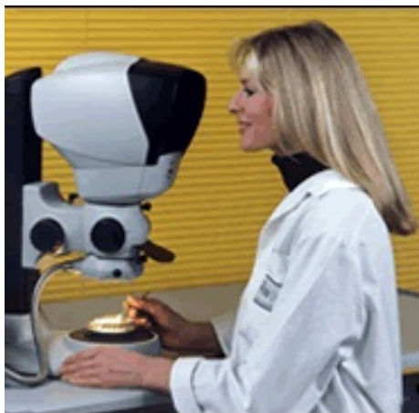
Рис. 3.5. Визуальный контроль с безокулярным стереомикроскопом LYNX
