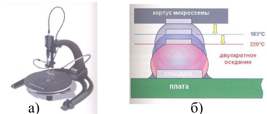
Рис. 3.7. Микроэндоскоп ERSASCOPE и его возможности
