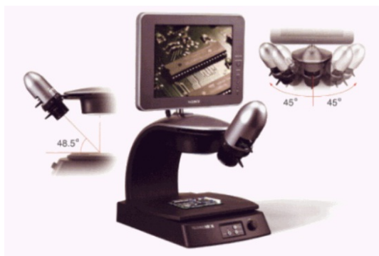
Рис. 3.6. Стереомикроскоп TechnoLOOK фирмы Sony Electronics
