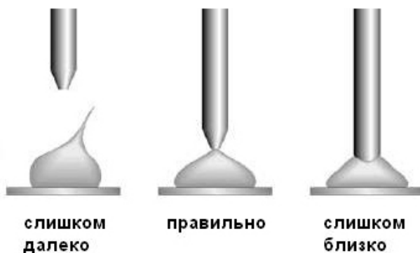
Рис. 1.9. Расположение наконечника дозатора
