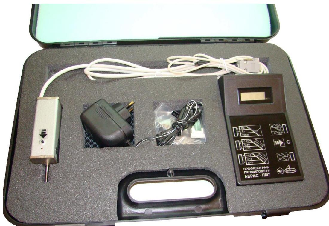
Рис. 1. Профилометр АБРИС ПМ7М
