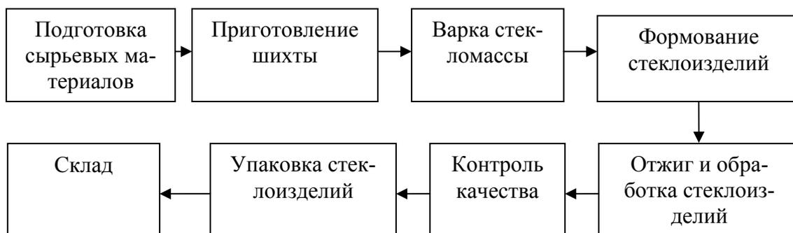
Рис. 10. Технологическая цепочка производства стеклопродукции традиционным способом
