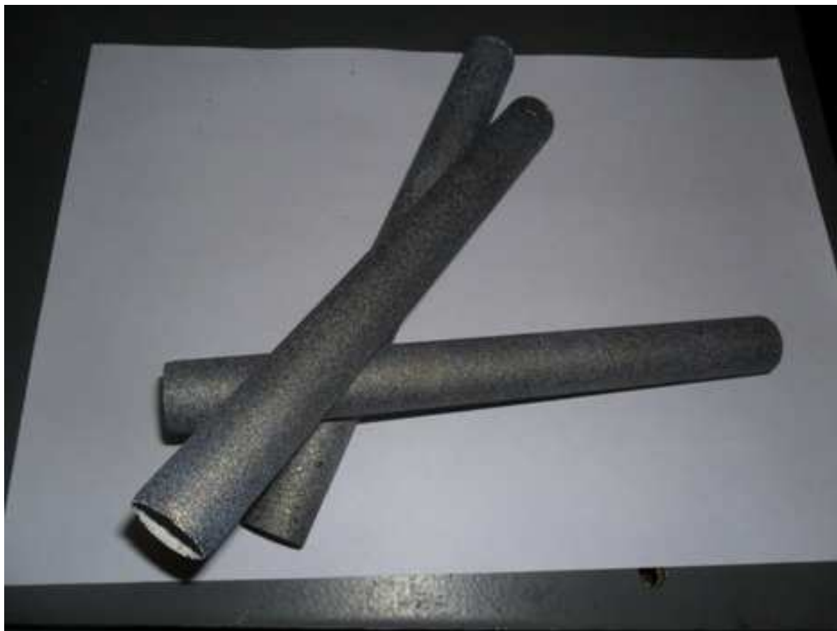
Рис. 2. Огнеупорные контейнеры для выращивания монокристаллов
