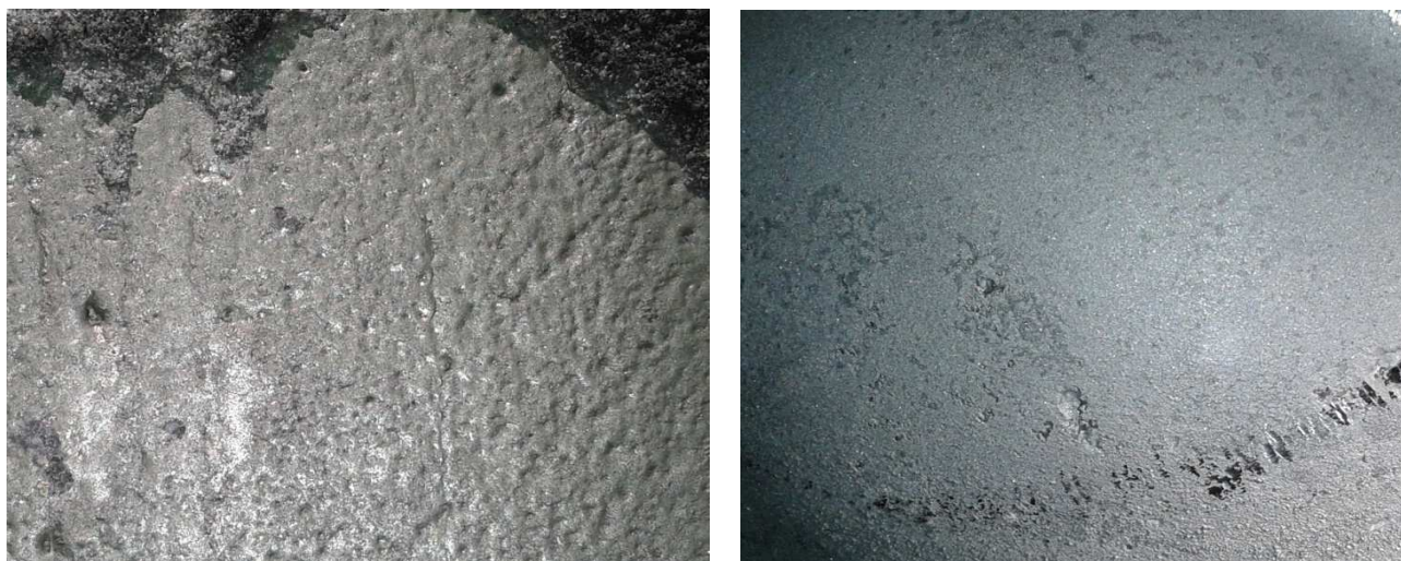
Рис. 2. Поверхность стальных отливок ( a – краска на основе графита, б – на основе циркона)
