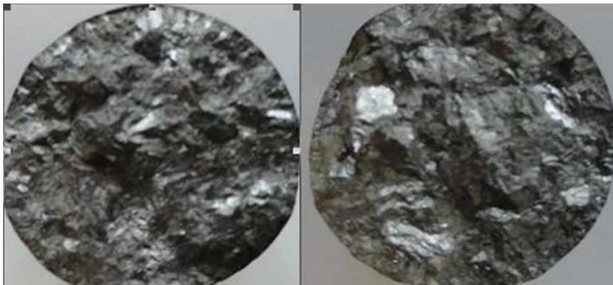
Рис. 3. Макроструктура поликристаллических заготовок из сплава ЮНДКТ5АА, содержащего ( слева ) и не содержащего ( справа ) гафний
