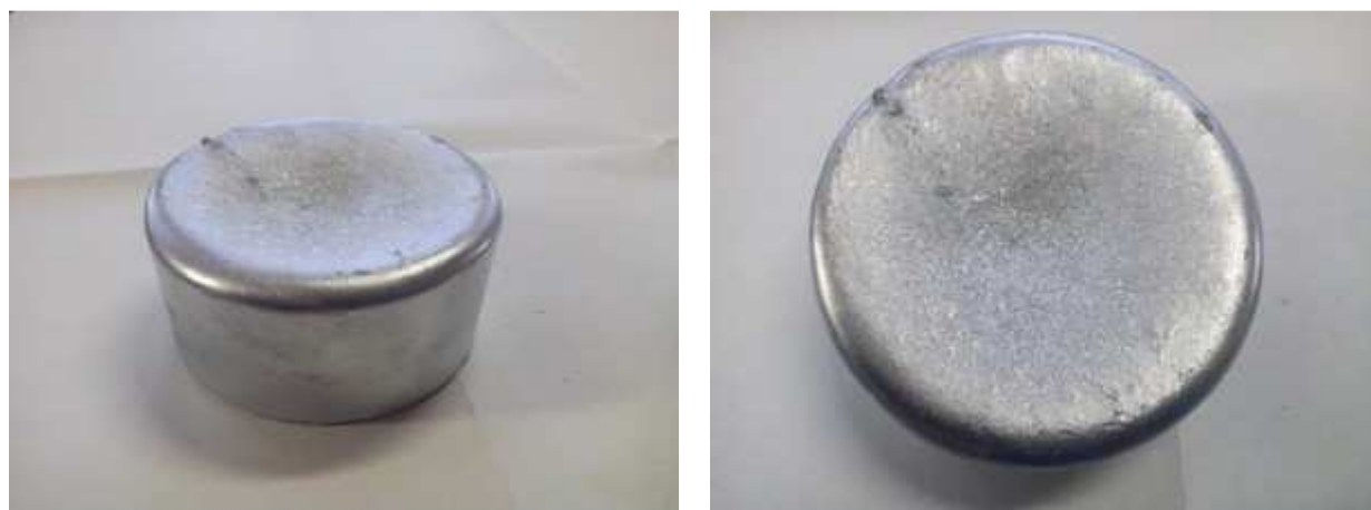
Рис. 1. Образец из сплава АК7ч по ГОСТ 1583-93 без применения методов рафинирования
