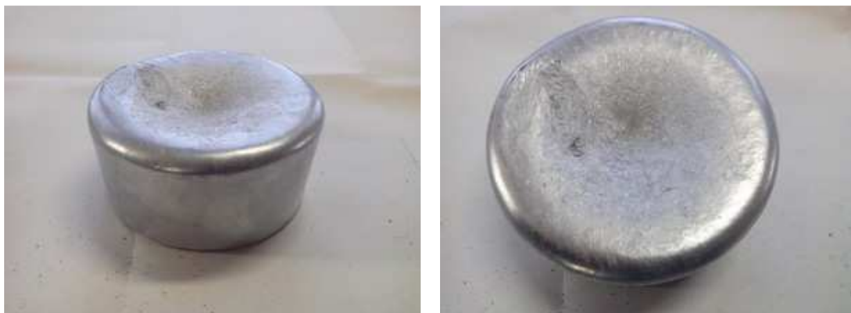
Рис. 2. Образец из сплава АК7ч по ГОСТ 1583-93, рафинированный флюсом ФУРМ
