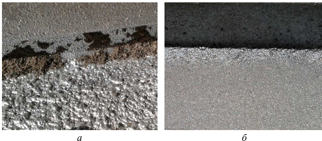
Рис. 1. Поверхность алюминиевых отливок оформленных стержнем (а – без противопопригарной краски, б – с противопопригарной краской)
