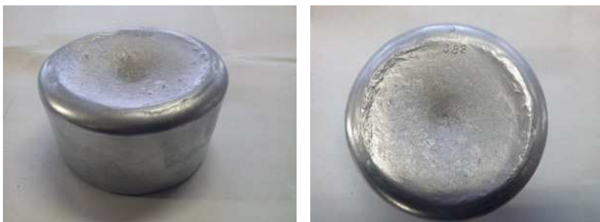
Рис. 3. Образец из сплава АК7ч по ГОСТ 1583-93 после продувки расплава инертным газом
