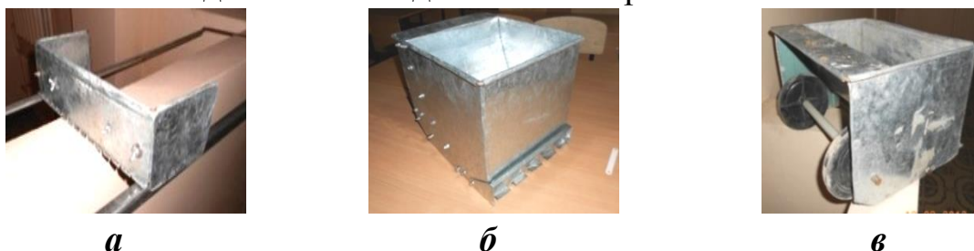
Рис. 2. Устройства для укладки ЛРШ (а, б) и ЛРШ на сетку
