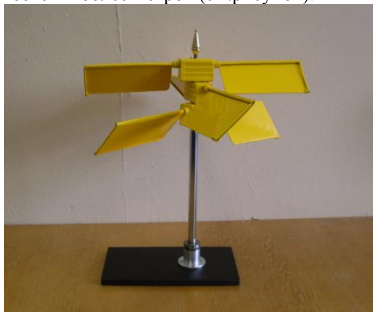
Рисунок – Общий вид энергоустановки с вертикальной осью вращения
