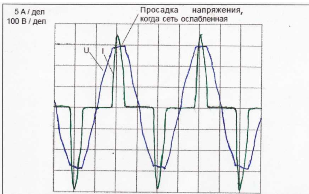
Рис. 7.6. Входные величины инвертора с однофазным подключением
