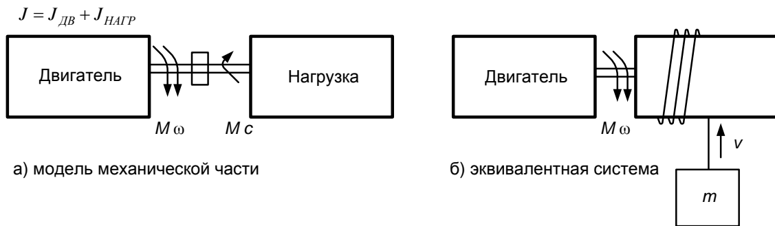
Рис. 4.3. Механическая система безредукторного лифтового привода
