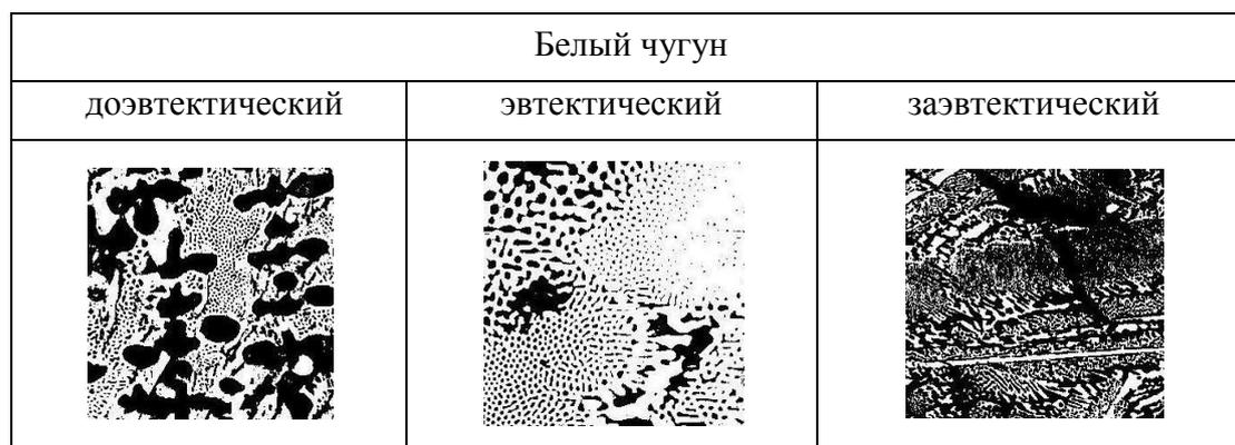
Рис.19. Микроструктуры белых чугунов
