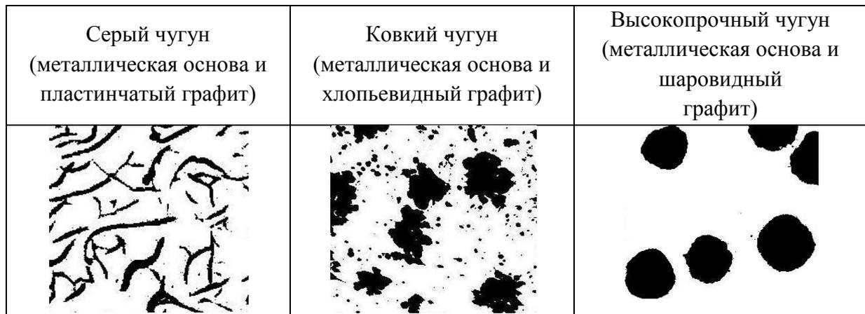
*Рис.20. Микроструктуры чугунов*
