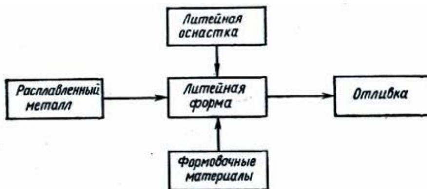
Рис. 35. Схема технологического процесса получения отливок в песчаных формах
