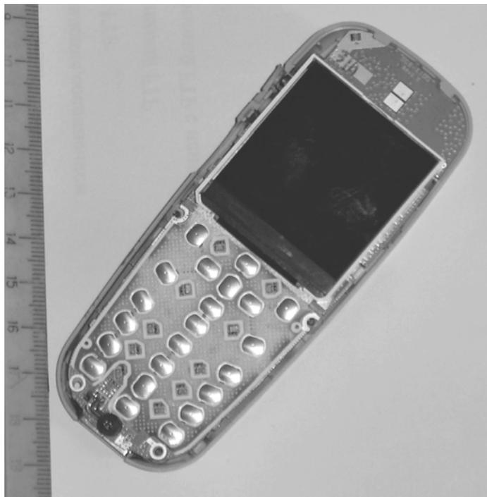
Рис. 1.2. Печатная плата сотового телефона со стороны дисплея
