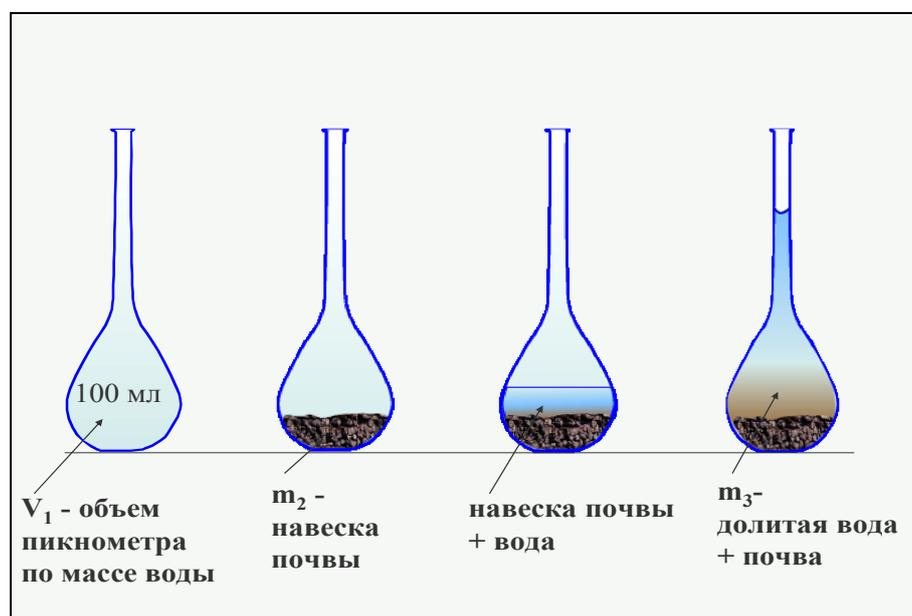
Рис. 2.10. Определение плотности твердой фазы почвы
