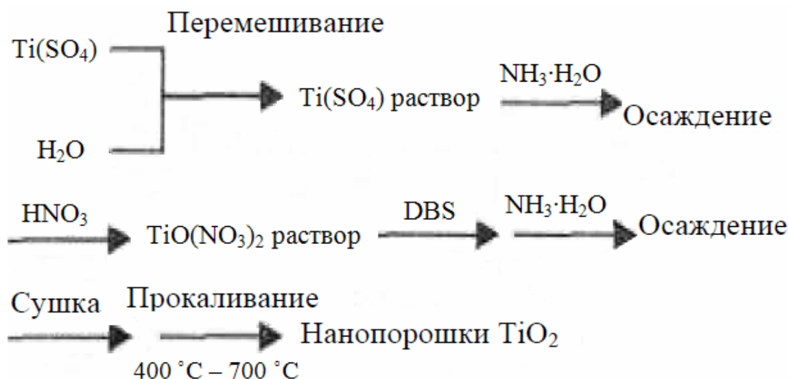
Рис. 3.47. Схема получения нано- TiO_2 (DBS-додецилсульфонатбензол)
