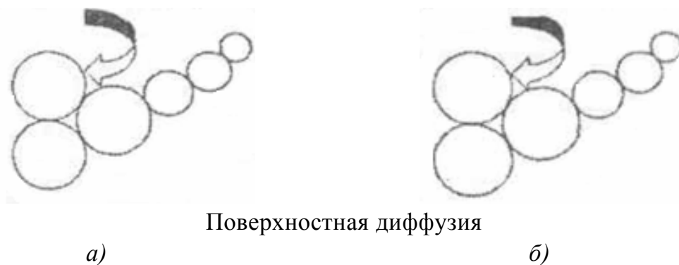
Рис. 2.57. Схема роста зерен порошков 8YSZ, прокаленных при различных скоростях нагрева: а – 100\text{ }^{\circ}\text{C}/\text{ч} ; б – 600\text{ }^{\circ}\text{C}/\text{ч} ; в – 250\text{ }^{\circ}\text{C}/\text{ч} ; г – нелинейный нагрев
