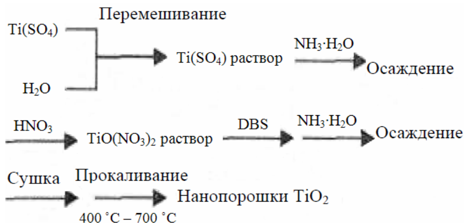
Рис. 3.126. Схема получения нанотитана TiO_2 (DBS додецил-сульфоната бензола)
