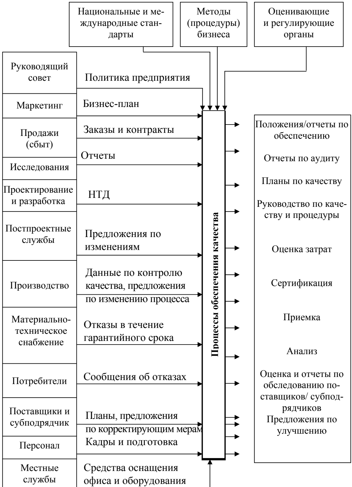
Рис. 7.3. Входные и выходные потоки для процессов подразделения обеспечения качества (Британский стандарт BS6143:1992)
