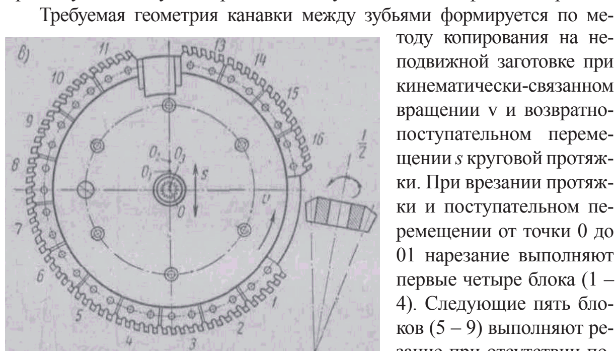
Рис. 13.20. Протягивание зубьев круговой протяжкой
