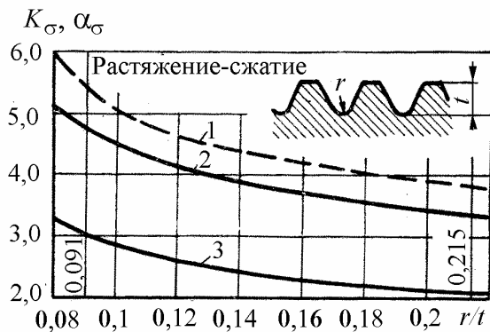
Рис. П9.1. 1 – \alpha_\sigma ; 2 – легированная сталь, d=12 мм; 3 – углеродистая сталь ( \sigma_B=400 МПа), d=12 мм; отношение r/t=0,091 соответствует метрической резьбе, а r/t=0,215 – резьбе Витворта.
