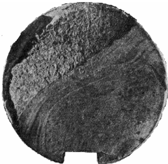
Рис. 15. Характерный внешний вид усталостного излома металла
