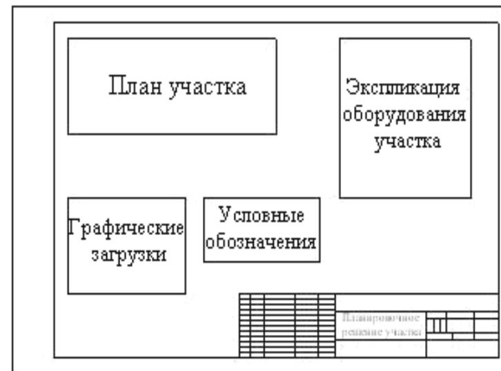
Рис. 7.3. Вариант планировки листа графической части проекта “Планировочное решение участка”
