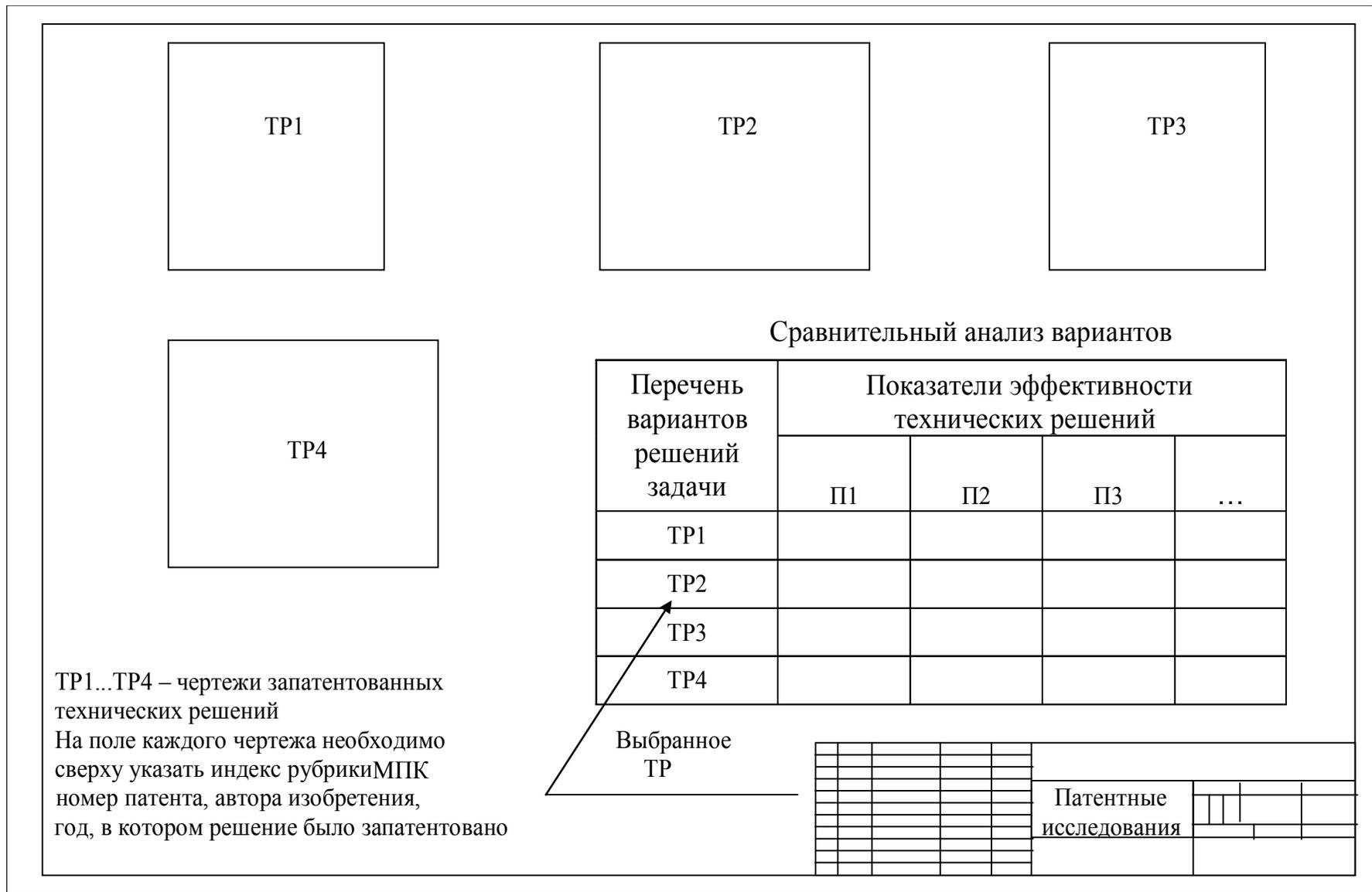
Рис. 7.2. Компоновка и содержание листа графической части по патентным исследованиям
