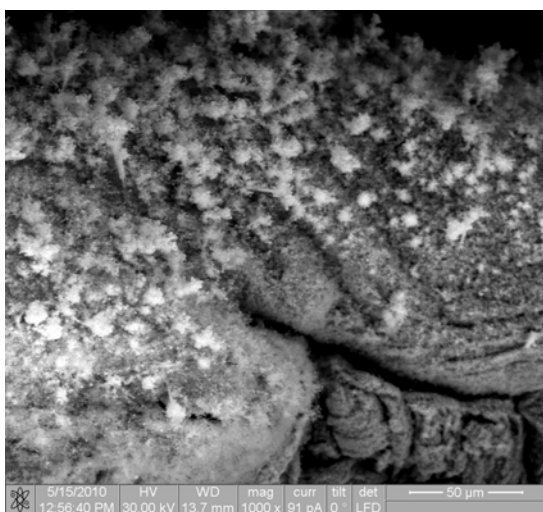
Рис. 1. РЭМ изображение массива структур в виде правильных четырехлучевых звезд
