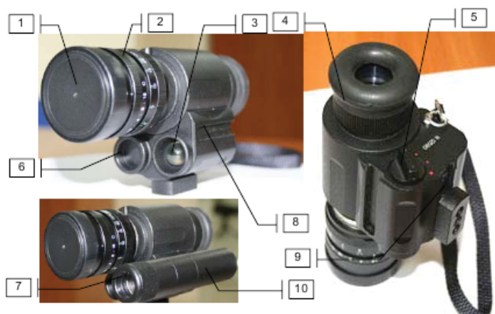
Рис. 1.3. Органы управления ПНВ Эдельвейс М400-Video: 1 – защитная крышка объектива; 2 – объектив; 3 – встроенный ИК осветитель; 4 – окуляр с диоптрийным кольцом и съёмным наглазником; 5 – переключатель режимов работы прибора; 6 – крышка батарейного блока прибора; 7 – съёмный лазерный ИК осветитель; 8 – направляющие на боковых стенках; 9 – направляющая на нижней стенке; 10 – съёмный лазерный ИК осветитель
