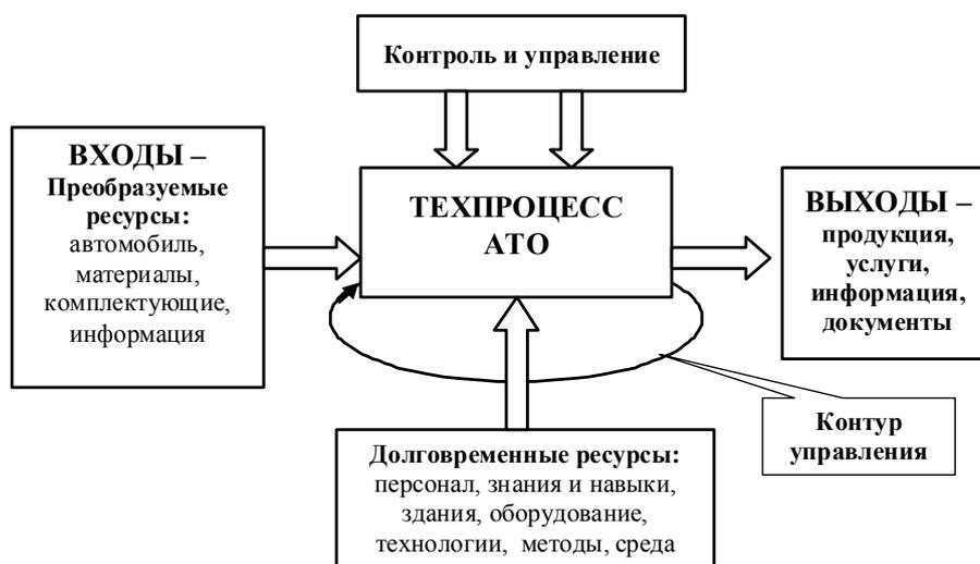
**Рис. 1.8. Модель типового процесса АТО и его основные компоненты**
