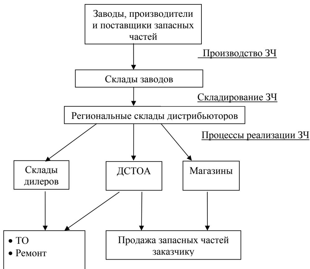
**Рис. 3.31. Схема поставок запасных частей в системе АТО**
