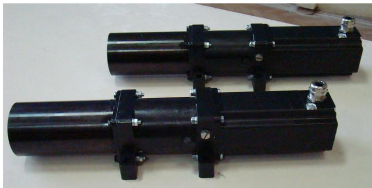
Рис. 7.21. Электромеханические приводы для станка электрохимической обработки деталей
