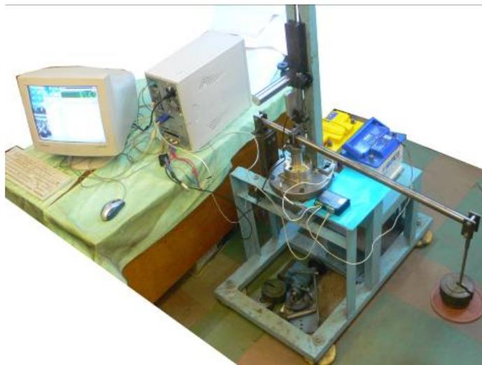
Рис. 8.28 Стенд для проведения экспериментальных исследований разрешающей способности нового облегченного актуатора
