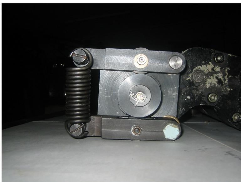
Рис. 8.41. Ударное устройство
