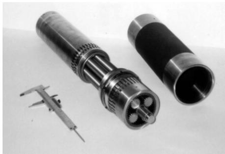
Рис. 7.16. Передача с длинными резьбовыми роликами РВПЗК 66×6
