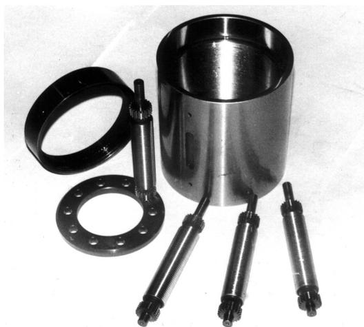
Рис. 7.6. Гайка и ролики передачи с короткими резьбовыми роликами РВПК 96×15
