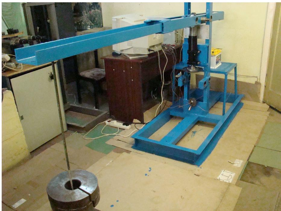
Рис. 8.33. Стенд при измерении КПД передачи
