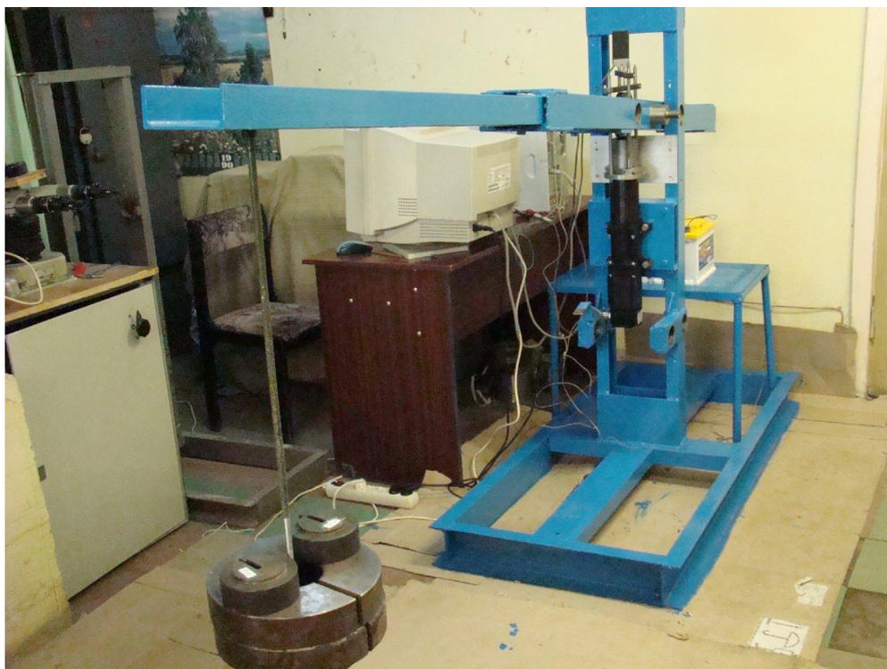
Рис. 8.31. Стенд при измерении грузоподъемности, жесткости и точности привода
