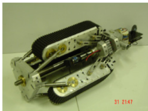
Рис. 1.38. Общий вид гусеничной системы передвижения МБР Crawler с пассивным механизмом поджатия движителя к внутренней поверхности трубопровода: а – раскрытое положение; б – исходное положение
