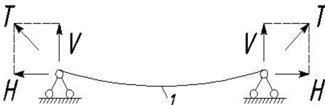
Рис. 1.3. Схема усилий, передаваемых на опорный контур: 1 – нить; H – распор; V – вертикальная составляющая; T – усилие нити
