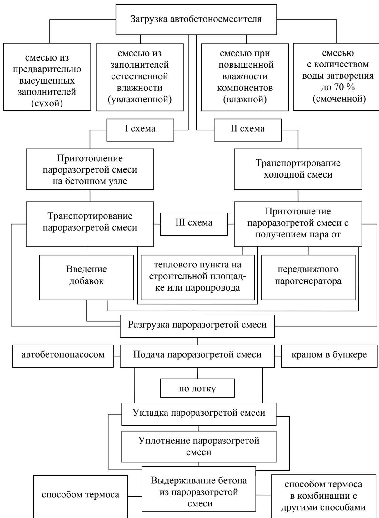
Рис. 1.8. Технологическая блок-схема бетонирования монолитных конструкций в зимнее время пароразогретыми в автобетоносмесителях смесями
