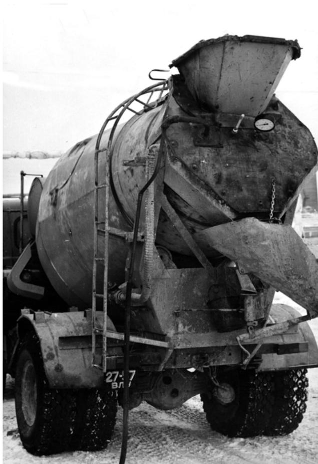
*Рис. 7.2. Дооборудование первого АБС С-1036 Б под пароразогрев*
