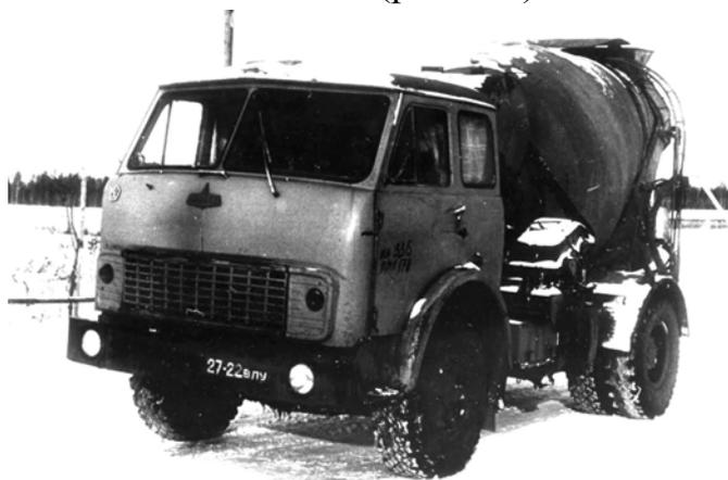
*Рис. 7.4. Дооборудование второго АБС С-1036 Б под пароразогрев бетонной смеси с утеплением смесительного барабана пенополиуретаном*
