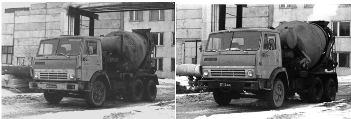
*Рис. 7.7. АБС СБ-92-1А, переоборудованные под пароразогрев*
