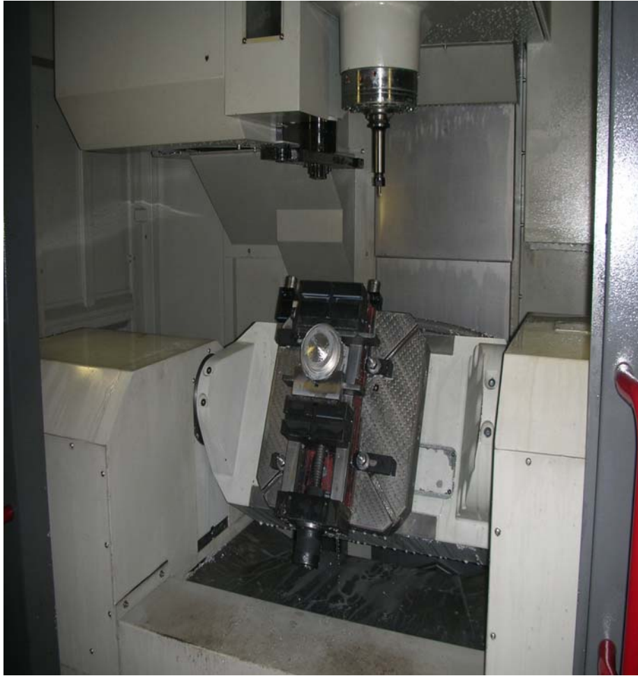
Рис. 1.3. Положение рабочего стола с тисками и круглой заготовкой после поворота относительно оси А
