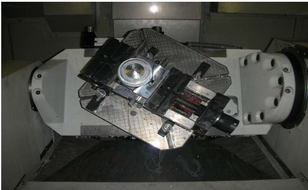
Рис. 1.4. Положение рабочего стола с тисками и круглой заготовкой после поворота относительно осей А и С
