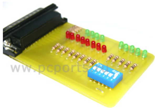
Рис. 1.2. Устройство, демонстрирующее работу параллельного интерфейса и LPT-порта
