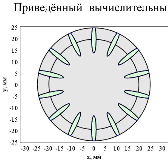
Рис. 4.36. Геометрические объекты ротора с открытой беличьей клеткой
