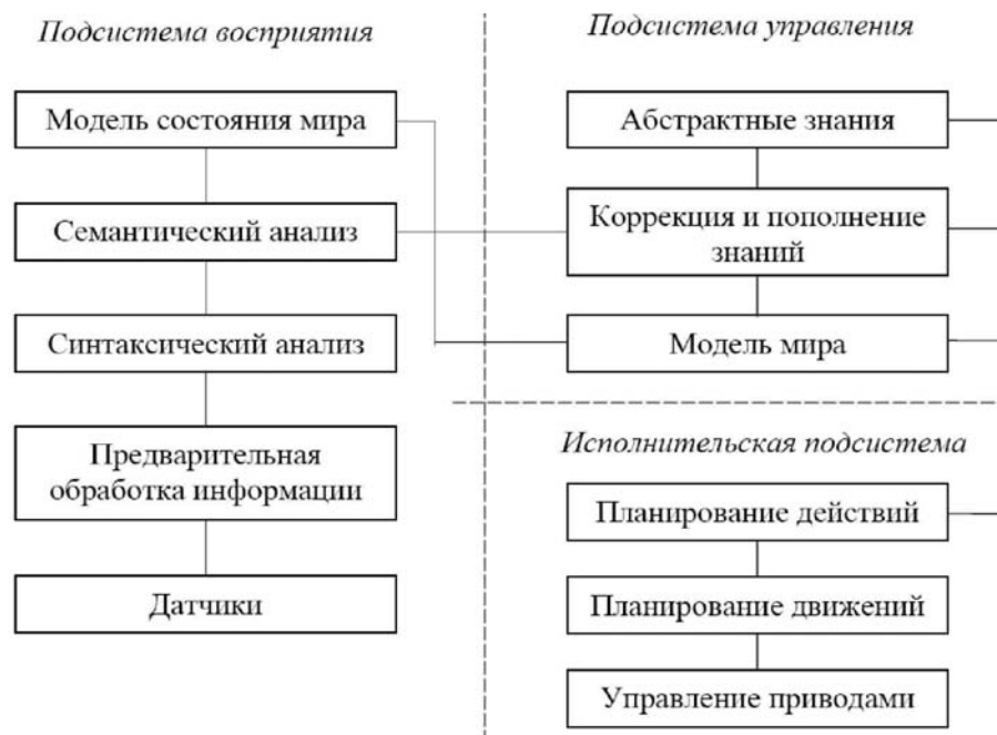
Рис. 6.3. Структура информационной системы интеллектуального робота
