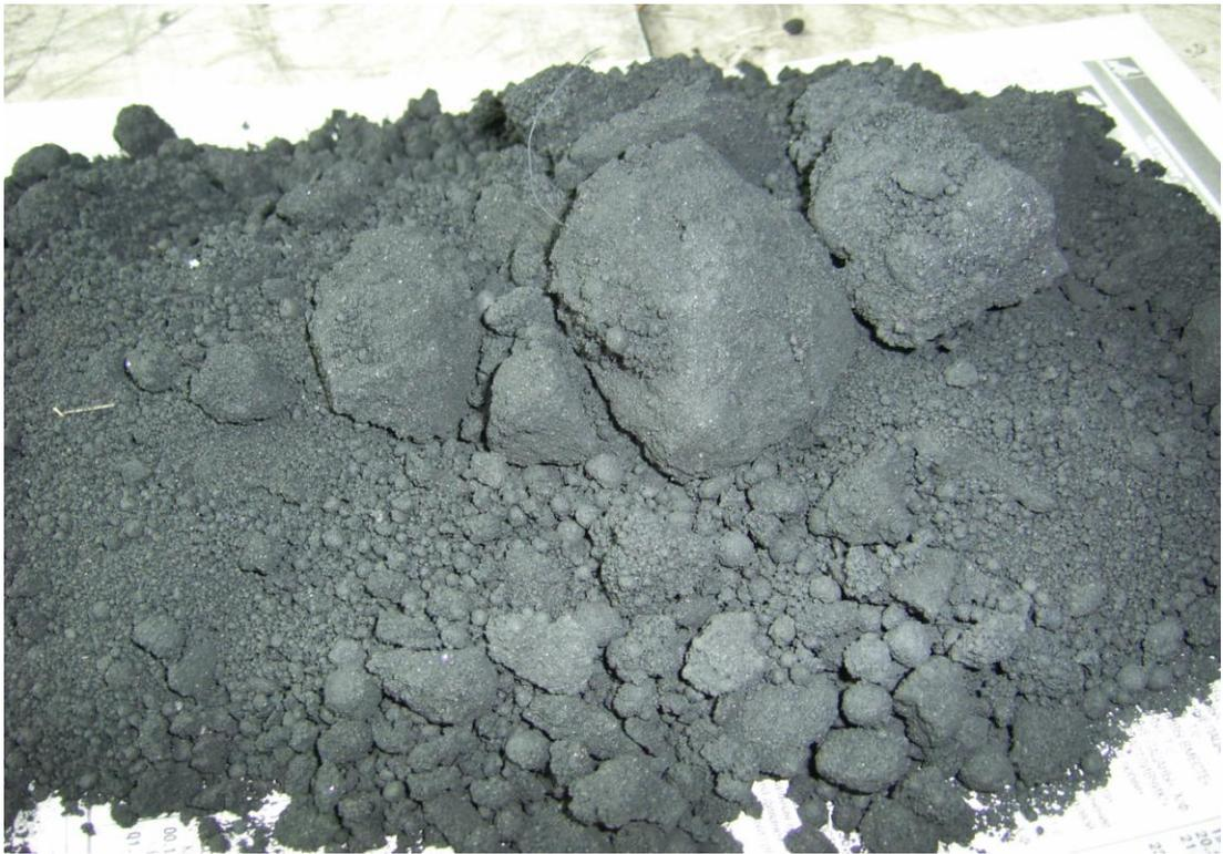
Рис. 10. Неметаллические отходы 1 группы: отработавшая формовочная смесь
