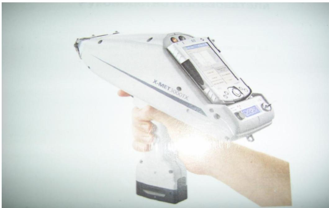
Рис. 15. Внешний вид портативного рентгенофлуоресцентного анализатора химического состава сплавов
