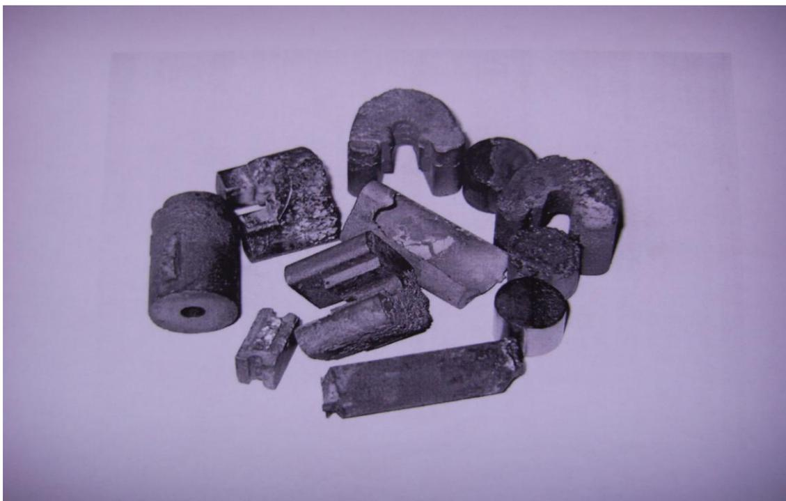
Рис. 3. Металлические отходы 2 группы: брак отливок, выявленный в литейном цехе (по химическому составу, по недоливам, по трещинам и т.п.)
