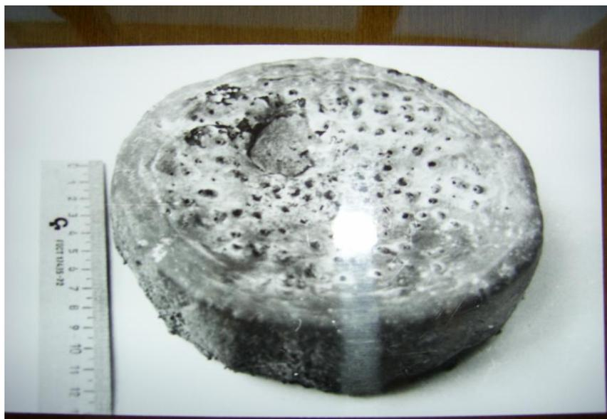
Рис. 20. Внешний вид металлического слитка, полученного методом алюминотермического восстановления в чугунной реакционной емкости
