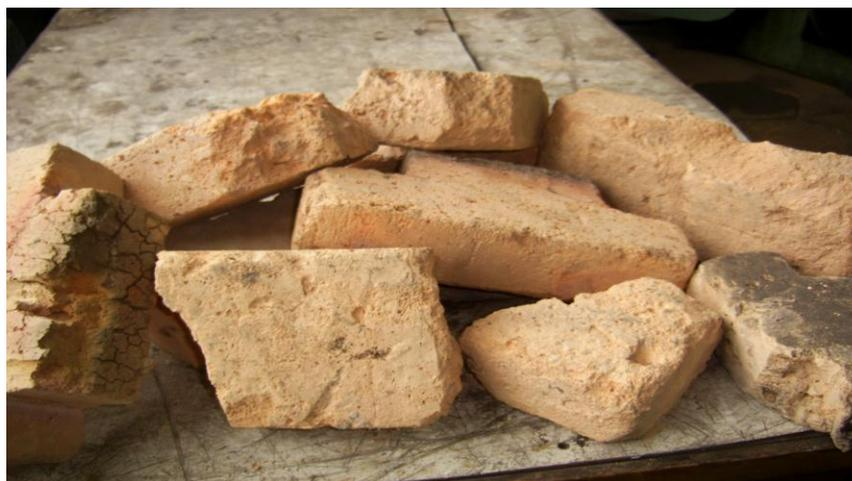
Рис. 12. . Неметаллические отходы 3 группы: лом футеровки прокаточной печи
