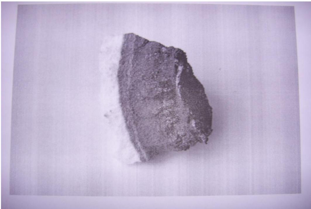
Рис. 11. Неметаллические отходы 2 группы: лом футеровки плавильной индукционной печи
