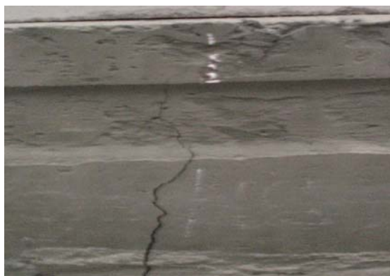
Рис. 2. Фрагменты раскрытия трещин при разрушении
