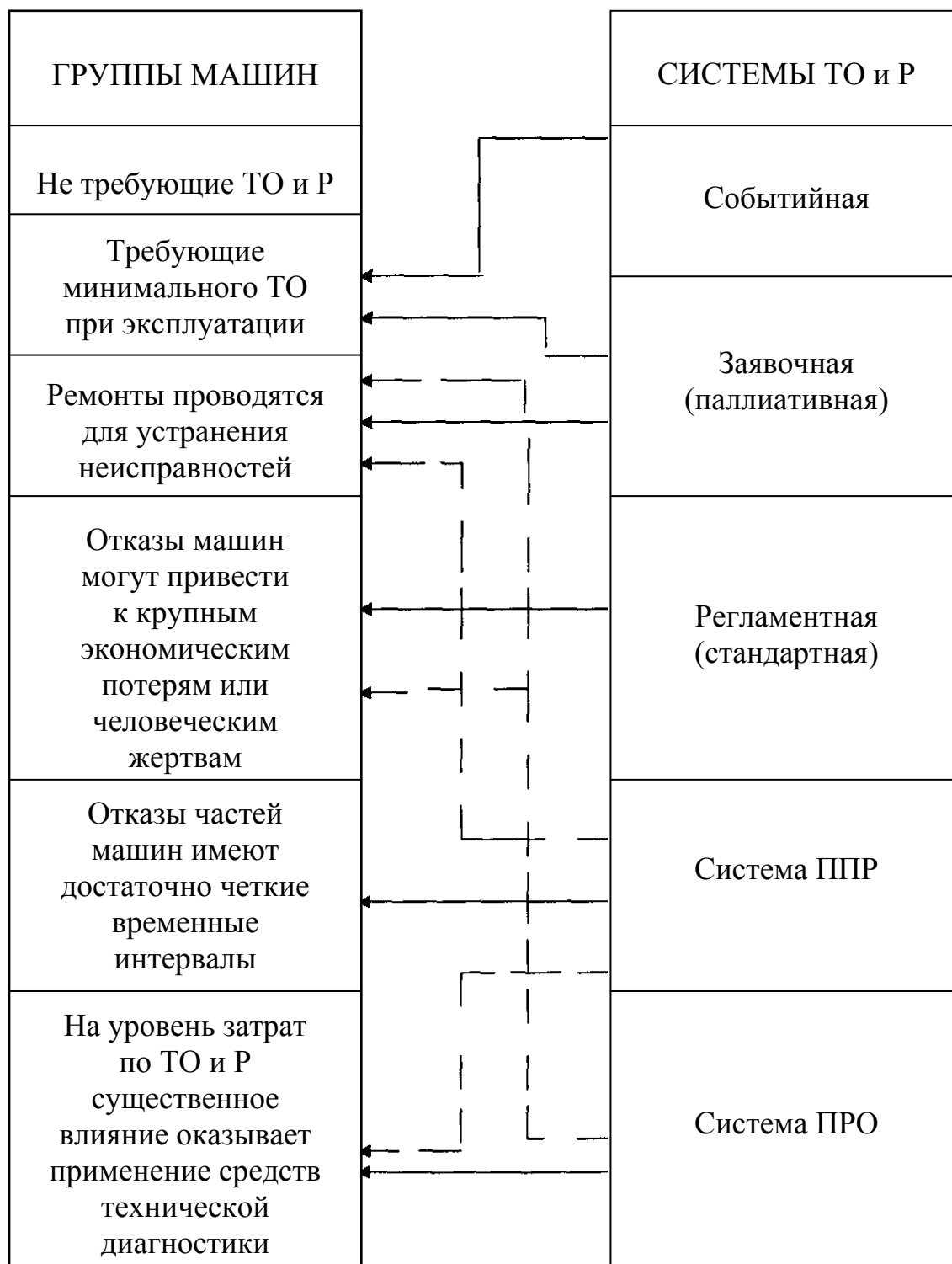
Рис. 2. Схема взаимосвязей групп техники с системами обеспечения работоспособности и исправности машин: —> — предпочтительные связи; - -> - допустимые связи
