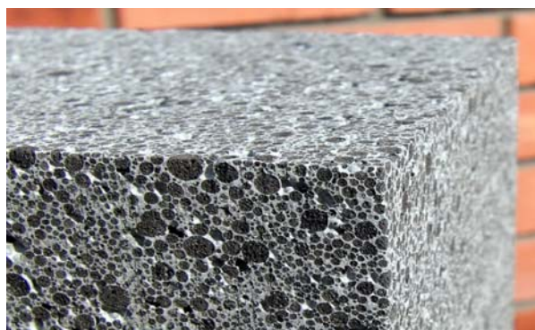
Рис. 2. Легкий бетон с гранулированным пеностеклом
