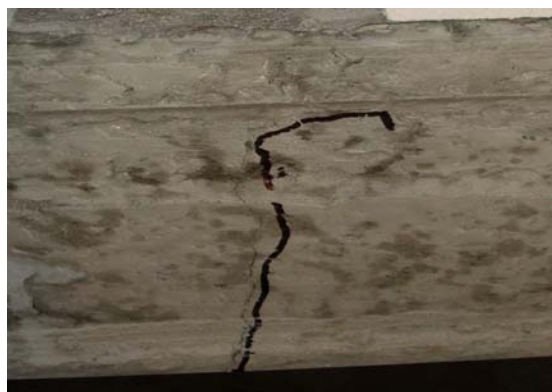
Рис. 2. Фрагменты раскрытия трещин при разрушении
