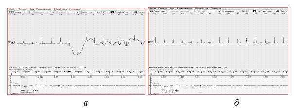
Рис. 1.7. Колебания изоэлектрической линии электрокардиограммы (а), правильная запись — изоэлектрическая линия горизонтальна (б)
