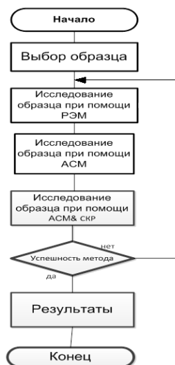
Рис. 3. Схема алгоритма методики мониторинга конструкторско-технологических параметров радиотехнических изделий
