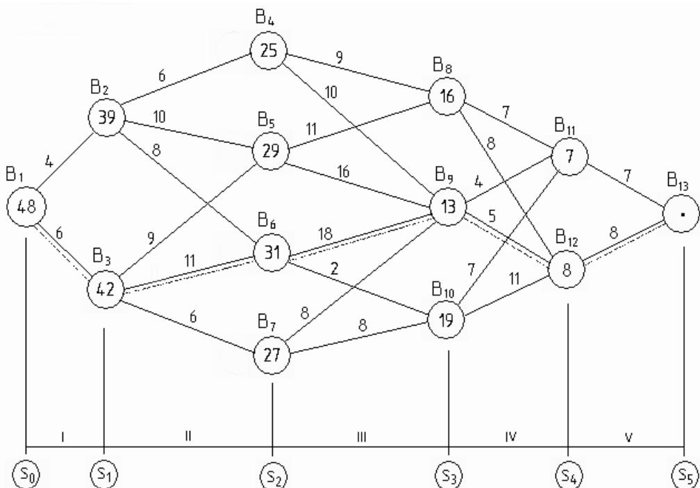
Рис. 2.3. Оптимальная схема движения автомобиля
