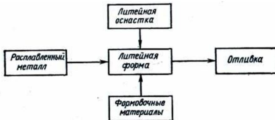
Рис. 7.1. Схема технологического процесса получения отливок в песчаных формах
