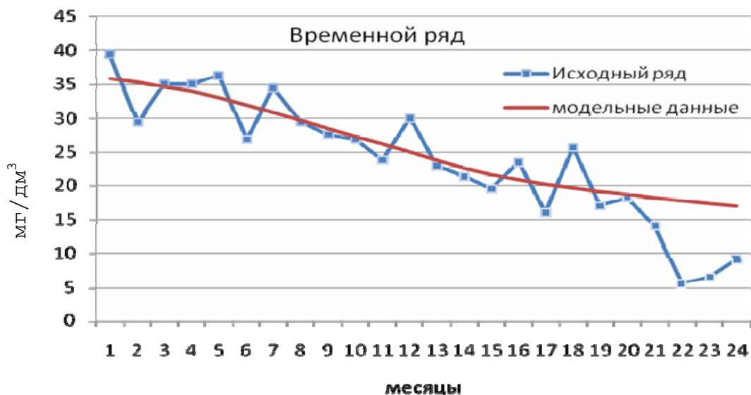
Рис. 4.3. Прогнозирование концентрации оксида азота в дымовых газах моделью на нечетких множествах
