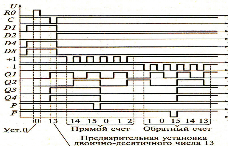
Рис. 3.6. Диаграмма работы счетчика K555IE7
