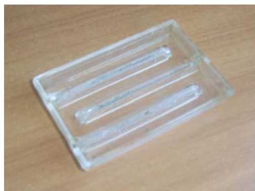
Рис.3. Камера Богорова для определения мелких червей, ракообразных и личинок насекомых
