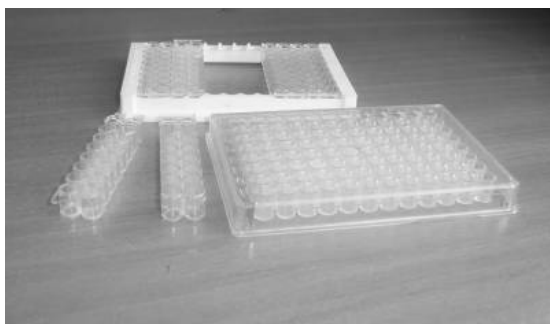
Рис. 12. Разные виды микролуночных планшетов для постановки опыта с простейшими
