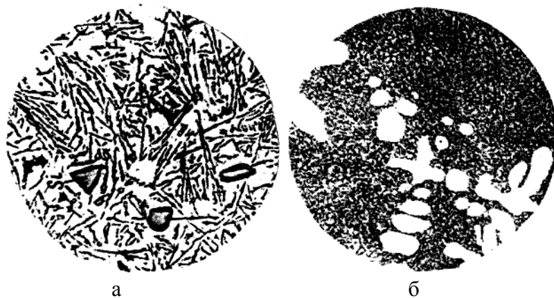
Рис.8.2. Микроструктура алюминиевого сплава АЛ2, х 250:
