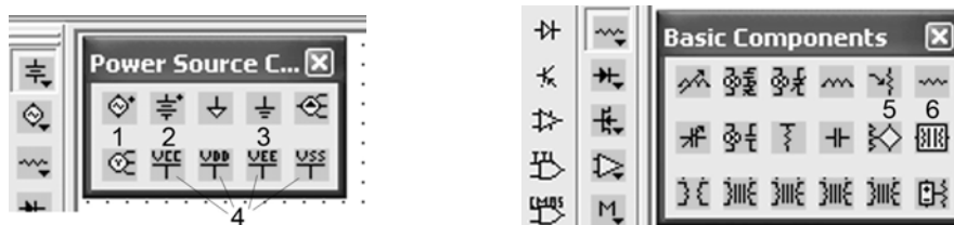
Рис. 1.2. Пиктограммы элементов: 1 - источник переменного напряжения; 2 - источник постоянного напряжения; 3 - общая точка; 4 - шины питания; 5 - потенциометр; 6 - резистор
