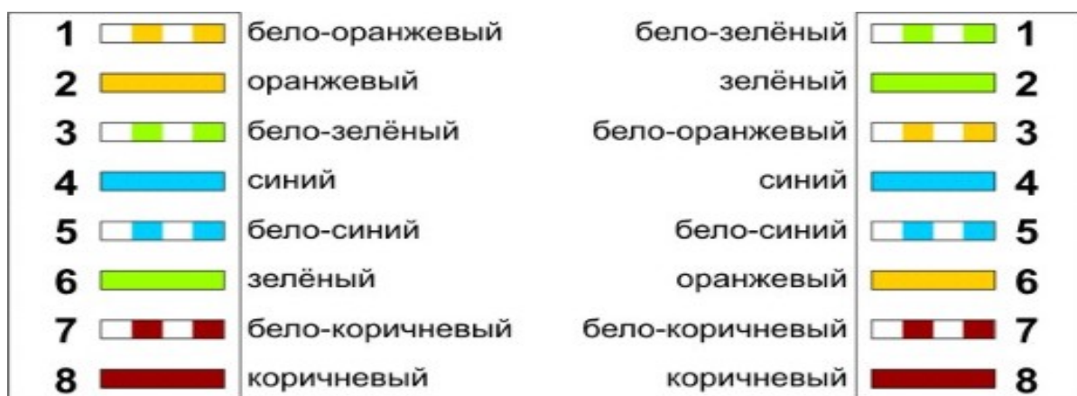
Рис. 8.22. Схемы обжимки кабеля: б – перекрёстный (кросс-овер) кабель (окончание)
