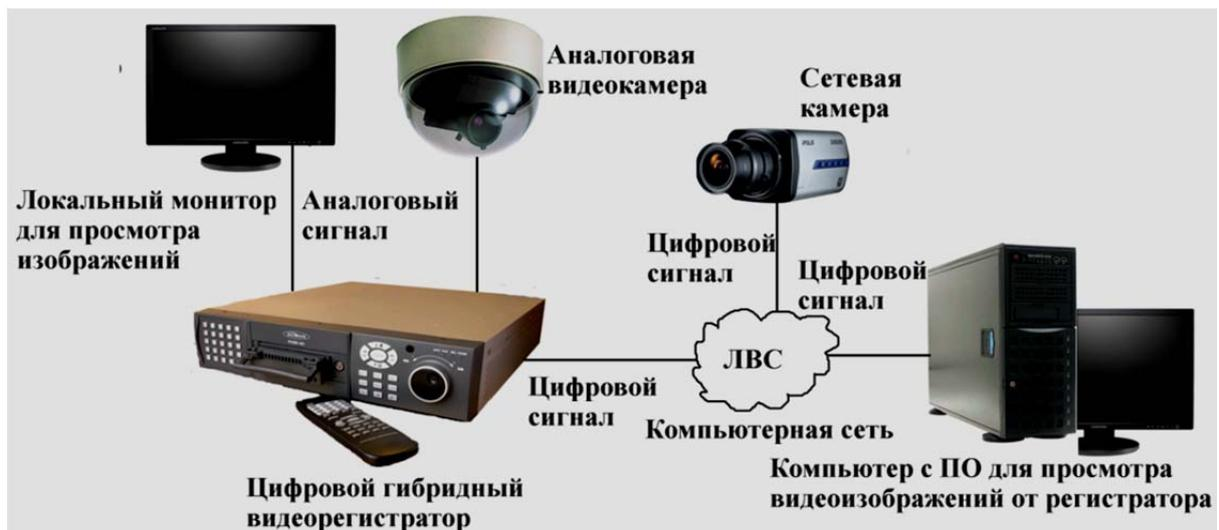
Рис. 14. Гибридная структурная схема системы видеонаблюдения на базе цифрового видеорегистратора
