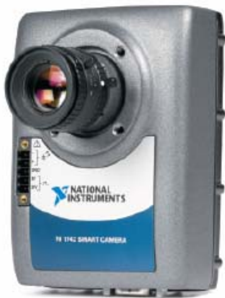
Рис. 6.1. Общий вид интеллектуальной камеры NI 1742
