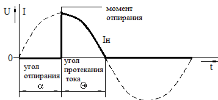
Рис. 121. Осциллограмма напряжения при фазовом способе управления
