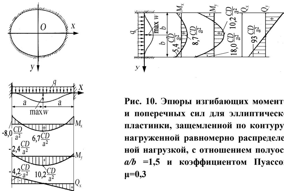
**Рис. 10.** Эпюры изгибающих моментов и поперечных сил для эллиптической пластинки, защемленной по контуру и нагруженной равномерно распределенной нагрузкой, с отношением полуосей  $a/b = 1,5$  и коэффициентом Пуассона  $\mu = 0,3$
