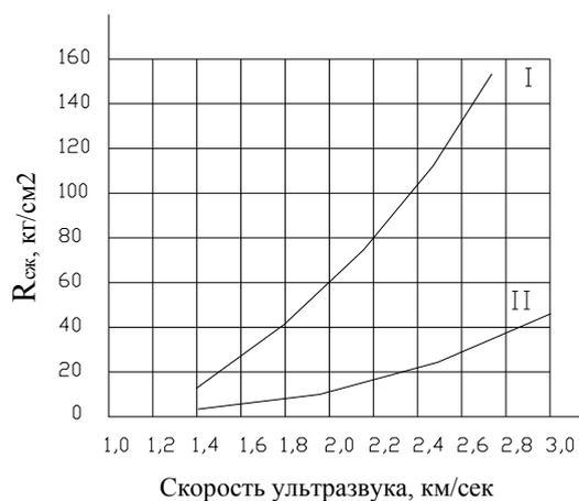
*Рисунок. Тарировочный график «скорость ультразвука – прочность газобетона»: I – кубиковая прочность при сжатии; II – прочность при изгибе*
